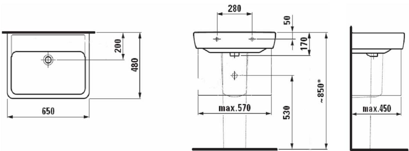
Bei Montage mit Säule ist die Montagehöhe nach dem effektiven Mass der Säule festzulegen.
