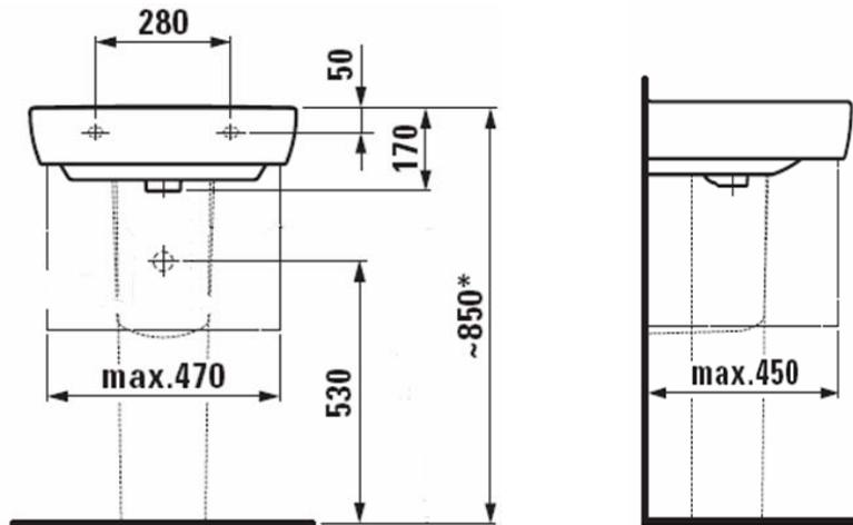
Bei Montage mit Säule ist die Montagehöhe nach dem effektiven Mass der Säule festzulegen.
