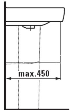
Bei Montage mit Säule ist die Montagehöhe nach dem effektiven Mass der Säule festzulegen.
