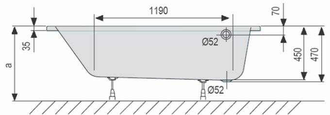
Einbauhöhe Wanne = min. 590mm / max. 650mm
